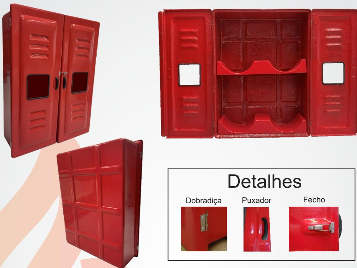
Abrigos para mangueiras, código 1293D confeccionados em PRFV (Plástico Reforçado com Fibras de Vidro). Dispensam pintura, pois são pigmentados durante a fabricação com gel coat aditivado contra raios Uv's.
